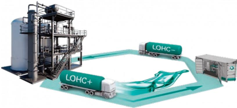
**Abbildung 4.16: Beispielhafter Transport des beladenen LOHC+ zur ReleaseUNIT und das entladene LOHC zur StorageUNIT<sup>28</sup>**
